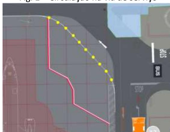
Fig. 2 – Pormenor: pinos a colocar e pintura da via e da ESA.
